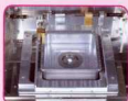
■ 外部驱动的X-Y平台 将样品放入样品室后 可对任意部位进行测量。
